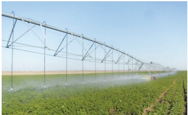
Рисунок 2 – Робота дощувальної машини із застосуванням сучасних спринклерів (i-Wob «Senninger»)
