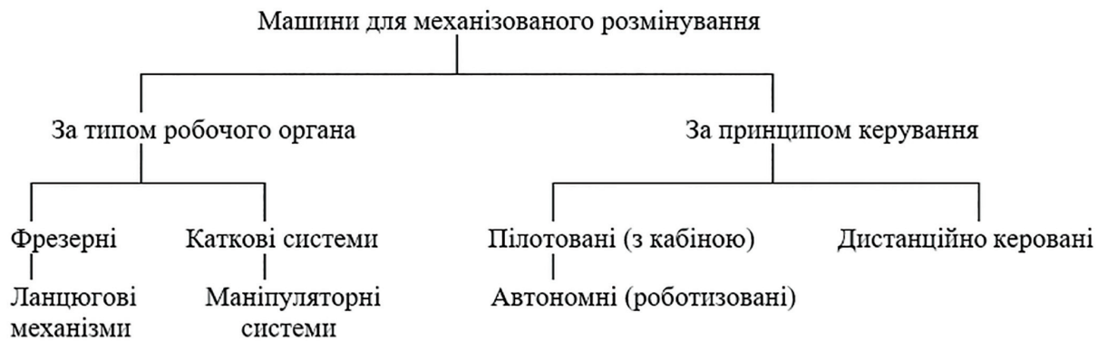
Рисунок 1 – Схема класифікації машин для механізованого розмінування
