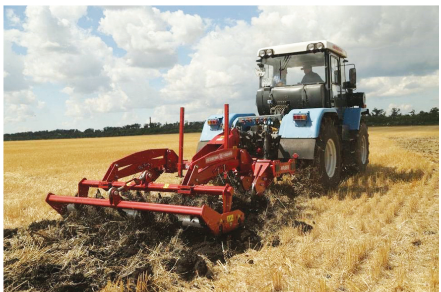
Рисунок 1 – Виконання технологічного процесу глибокого обробітку ґрунту агрегатом «ХТЗ-17221» + глибокорозпушувач «ГРУ-2,5» (Франк-2,5)
