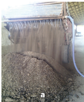
Рисунок 3 – Водорозподільний пристрій для серійного розкидача органічних добрив типу «ПРТ-10» (рис.3 а) і технологічний процес переформування бурту зі зволоженням сировини (рис.3 б)
