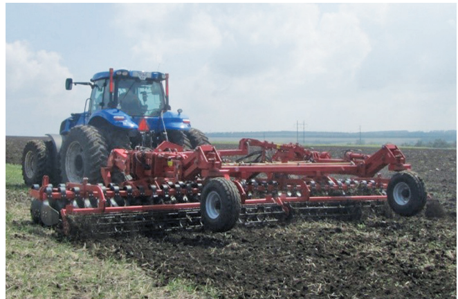
Рисунок 2 – Виконання технологічного процесу ґрунтообробки агрегатом трактор «New Holland Т8.390» + агрегат ґрунтообробний «ДЛМ-8» у ході випробувань
