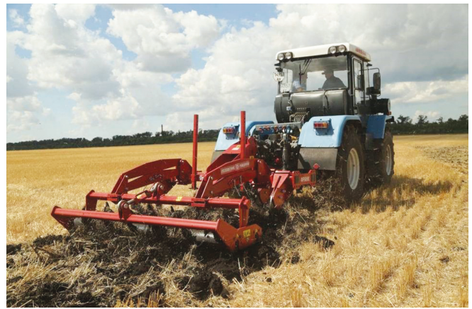
Рисунок 1 – Виконання технологічного процесу глибокого обробітку ґрунту агрегатом «ХТЗ-17221» + глибокорозпушувач «ГРУ-2,5» (Франк-2,5) під час випробувань
