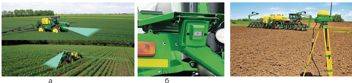
Рисунок 10 – Ілюстрація системи корекції положення агрегата «Guidance Radio RTK» фірми «Deere & Company» [Radio RTK 900, 2023]
