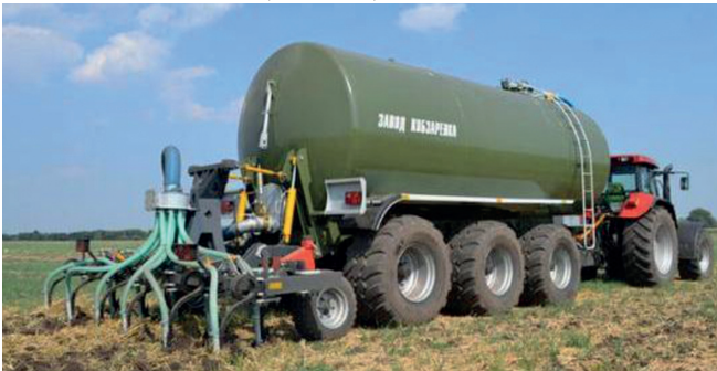
Рисунок 4 – Транспортно-технологічний агрегат Case IH Magnum 250 + ВНЦ-30 внесення рідких органічних добрив у роботі
