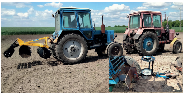
Рисунок 2 – Проведення тягових випробувань дискової борони GiaRDino
