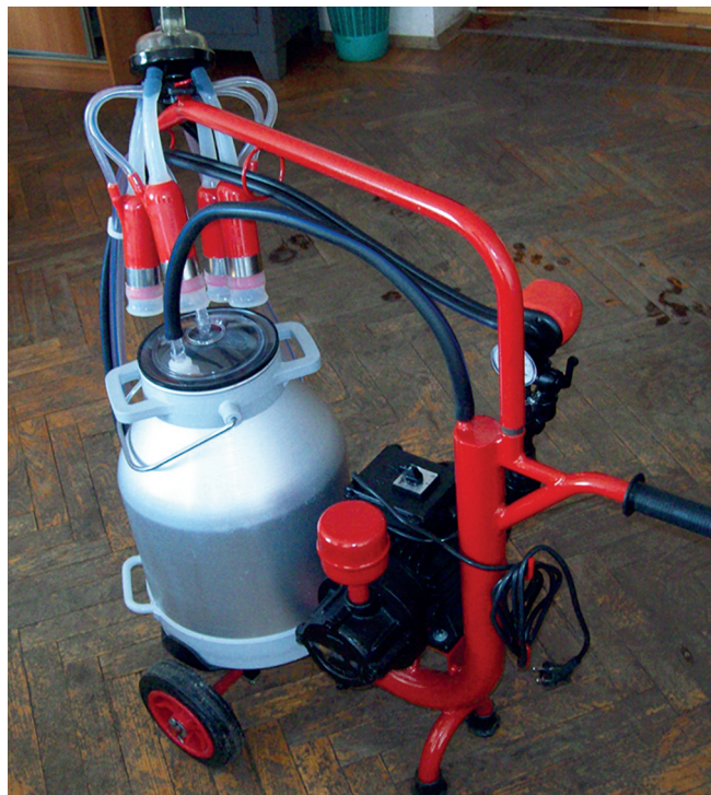
Рисунок 1 – Загальний вигляд індивідуальної доїльної установки «Kurtsan»
