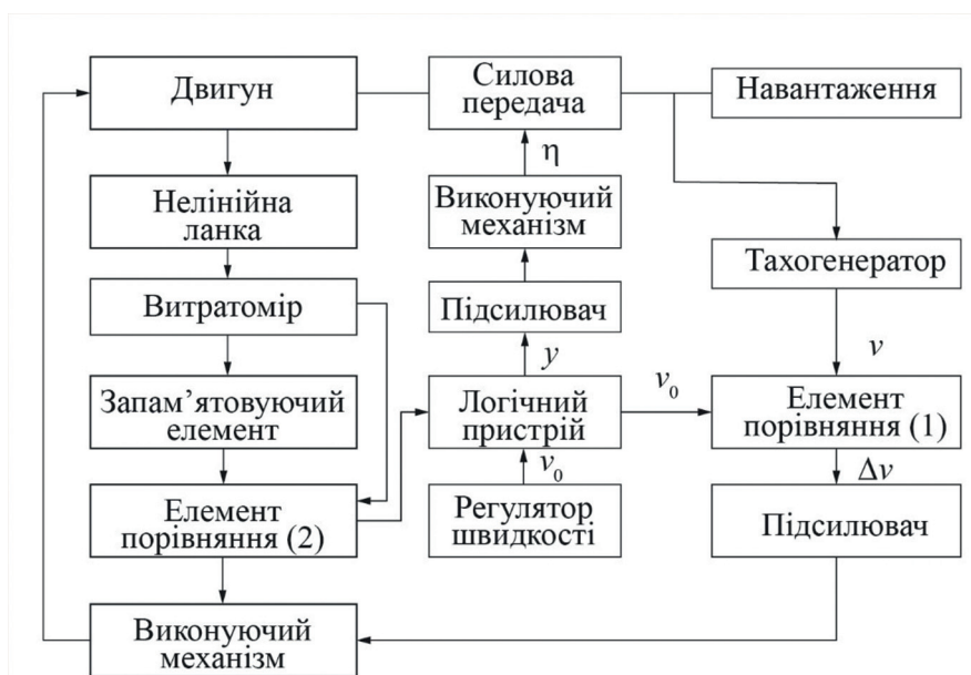
Рисунок 1 – Схема екстремального регулятора руху трактора
