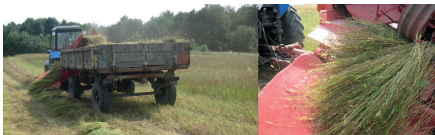
Рисунок 3 – Збирання льону олійного льонозбиральним комбайном ЛК-4А
