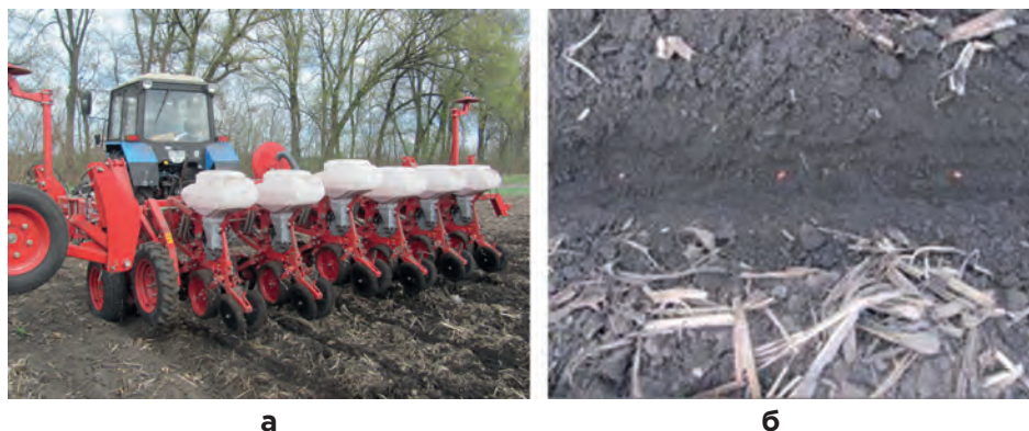
Рисунок 5 – Просапна сівалка ВЕГА-8 на сівбі кукурудзи: а) загальний вигляд; б) розкладене в рядку насіння
