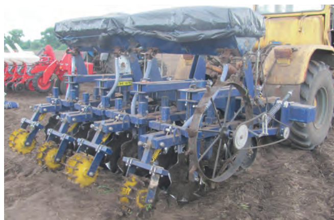
Рисунок 3 – Загальний вигляд 4-рядного агрегата СТА-4 для смугового обробітку ґрунту з одночасним внесенням мінеральних добрив
