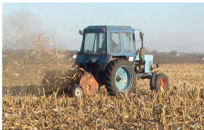
Рисунок 8 – Подрібнювач ПН-2 в агрегаті з трактором МТЗ-80 у роботі
