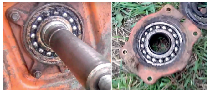
Рисунок 1 – Спрацьованість підшипникових вузлів молотильного барабана зернозбирального комбайна
