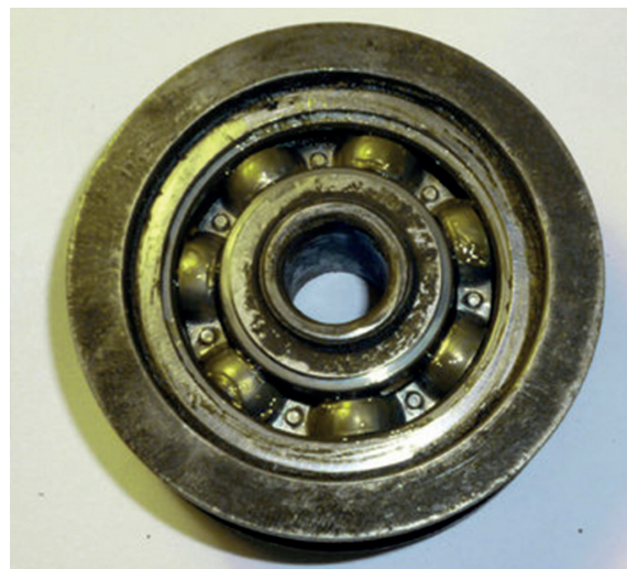
Рисуюнок 4 – Оснащення по забезпеченню жорсткості та рівномірності розподілу діючого на підшипник навантаження
