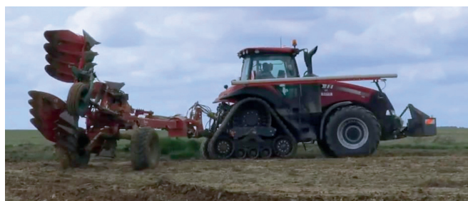
Рисунок 4 – Трактор Case IH Magnum 380 Rowtrac в агрегуванні з плугом Kverneland RW 100 на поворотній смузі
