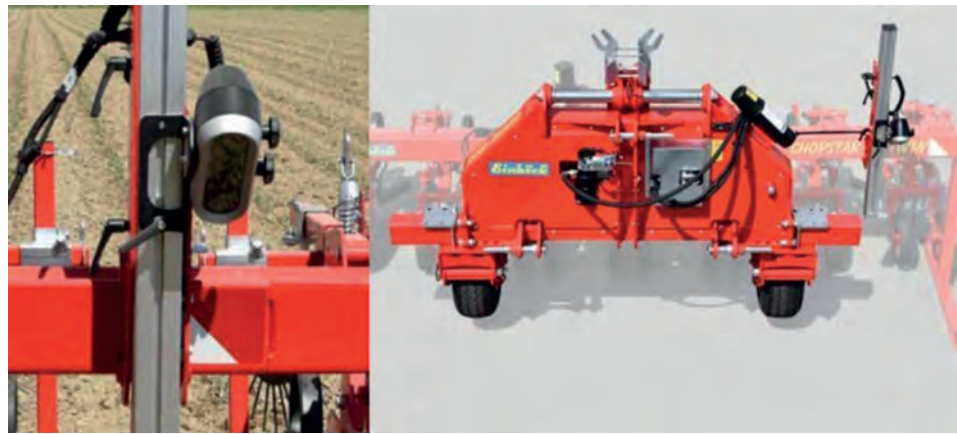
Рисунок 13- Основні елементи Camera steering system ROW-GUARD фірми Einbock GmbH&Co [31]: а - відеокамера з двома об'єктивами високої чіткості з різною експозицією для поліпшення роботи зі зміною умов світла; б - система зміщення культиватора відносно рядка рослин
