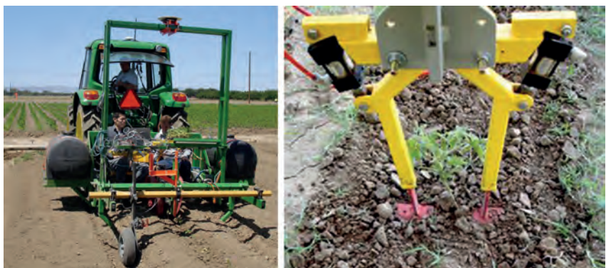
Рисунок 2 – Фотографії демонструють роботу автоматичної системи механічного видалення внутрішньорядних бур'янів на базі автоматизованої системи картографування трансплантатів RTK-GPS на фермі кампусу університету California, Davis [8]
