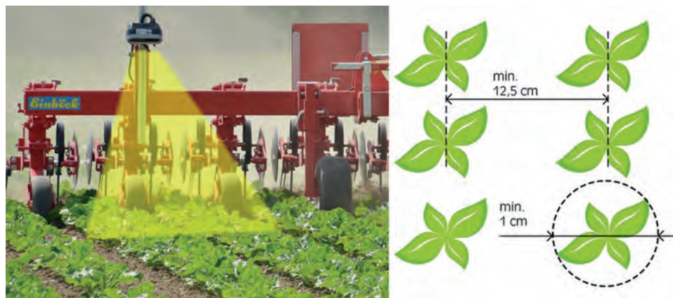
Рисунок 14- Вигляд Camera steering system ROW-GUARD під час роботи [31]
