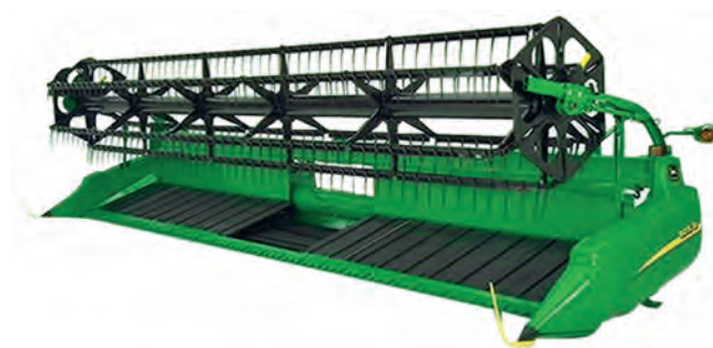
Рисунок 6 - Стрічкова зернова жатка 900D фірми «JOHN DEERE» [21]
