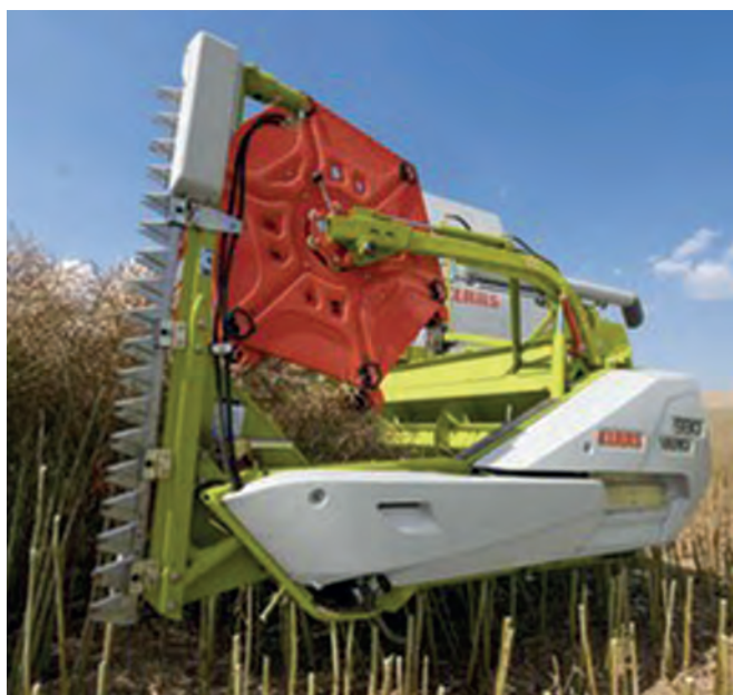
Рисунок 4 - Активний подільник жатки Vario компанії CLAAS [19]
