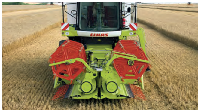
Рисунок 8 - Секційна (складена) жатка компанії «CLAAS» [19]
