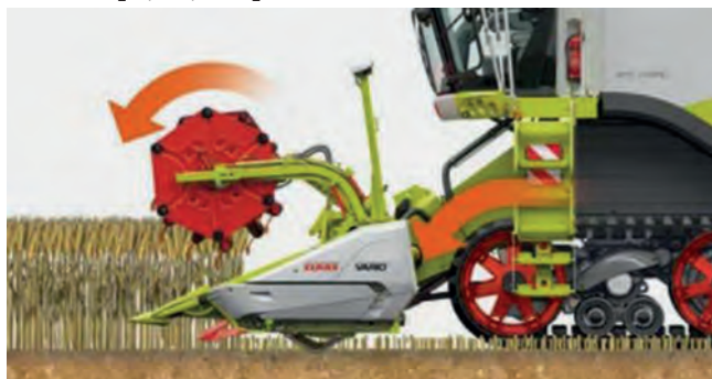
Рисунок 3 - Система синхронізації частоти обертання мотовила і швидкості руху зернозбирального комбайна [19]
