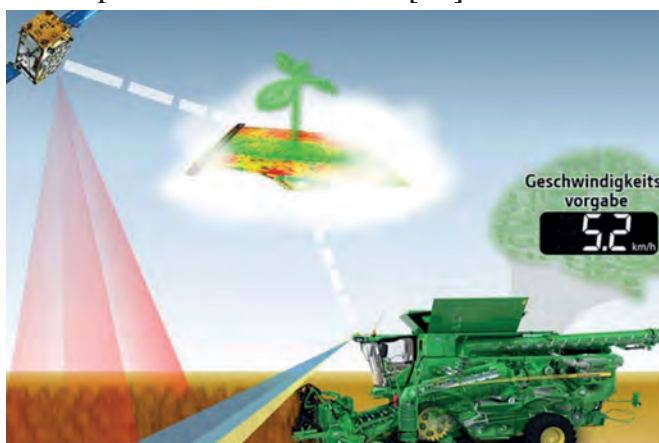
Рисунок 15 - Схема функціонування проактивного контролера пропускної здатності із встановленням 3D-камер зернозбирального комбайна JOHN DEERE [21]
