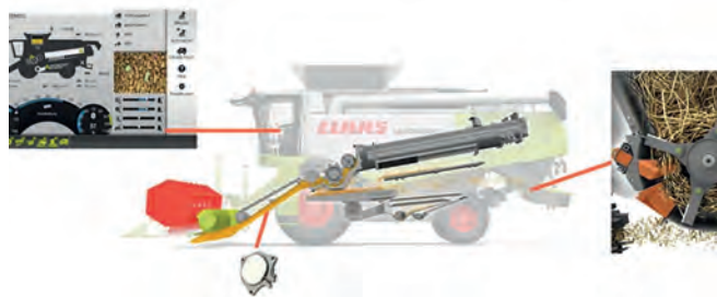
Рисунок 14 - Система Cemos Auto Chopping компанії «CLAAS» для автоматичної оптимізації роботи подрібнювача соломи зернозбирального комбайна [19]
