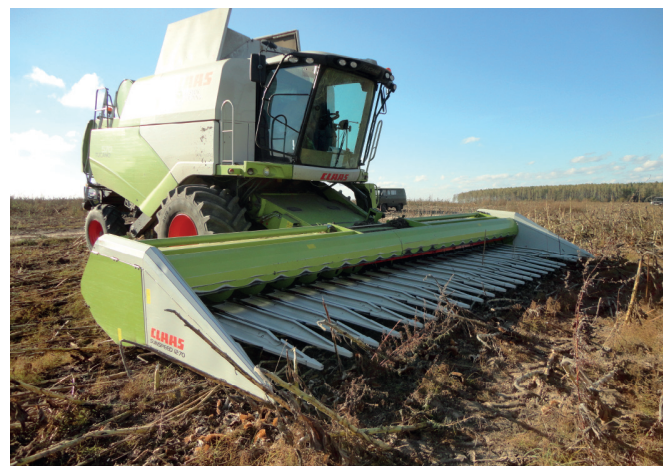
Рисунок 6 – Комбайн Tucano -570 С з жаткою для збирання соняшника
