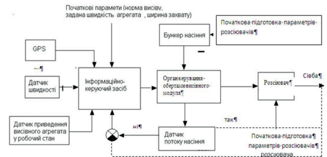
Рисунок 4 – Схема управління технологічними процесами в лабораторних і польових дослідженнях
