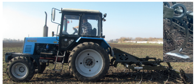
Рисунок 1 – Культиватор TallAr-2,8H та його робочий орган – двовитковий кільцевий демпфер з культиваторною лапою
