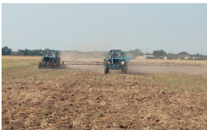
Рисунок 2 – Внесення деструкторів з одночасним загортанням у ґрунт
