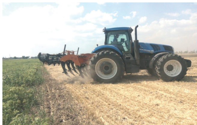
Рисунок 5 – Обробіток ділянки за допомогою GPS навігації трактором New Holland та глибокорозпушувачем SPIDER 40-42 см
