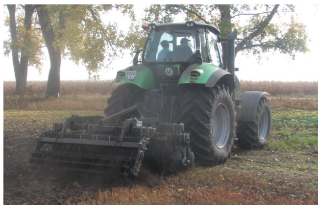
Рисунок 2 – Загальний вигляд дискового агрегата T-allAr-2,5 в агрегаті з трактором Deutz Fahr Agrottron X 720 під час виконання технологічного обробітку ґрунту
