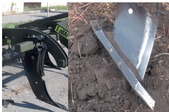
Рисунок 4 – Глибокорозпушувальна лапа: а – стійка в зборі; б – робоча площина асиметричної стійки з реверсивним долотоподібним наконечником
