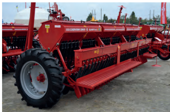
Рисунок 1 – Сівалка СЗТ 5.4 (ПАТ «Червона зірка»)
