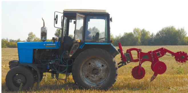
Рисунок 2 – Експериментальна секція агрегата для смугового обробітку ґрунту
