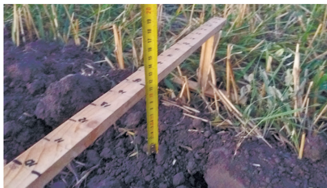
Рисунок 3 – Вимірювання поперечної нерівності
