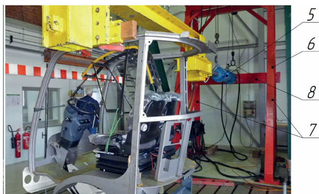
Рисунок 2 – Стенд фірми «Lochmann» для проведення випробувань статичним горизонтальним навантаженням [7] (вигляд збоку)
