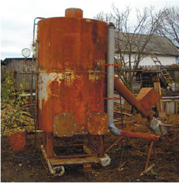
Рисунок 2 – Ферментер та установка для подачі органічної маси
