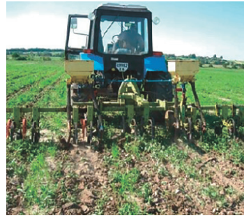
Рисунок 1 – Міскантусосаджальна машина (а) та культиватори для міжрядного обробітку (б) і прикореневого підживлення (в) рослин міскантусу.
