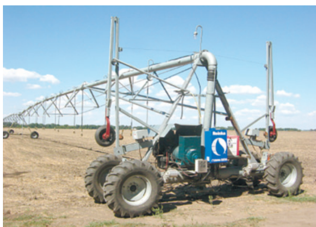
Рисунок 5 – Дощувальна машина фронтальної дії поворотна «Reinke» E2065-G4WD 387,5м
