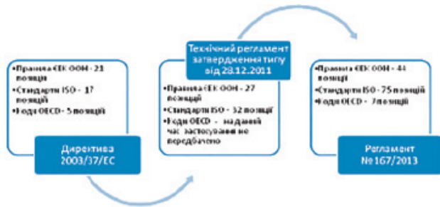
Рисунок 2 – Застосування міжнародних норм і правил в документах із затвердження типу тракторів, причепів, причіпних машин
