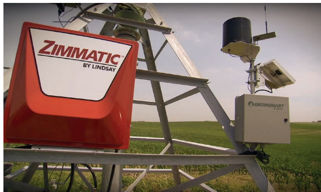
Рисунок 8 – Метеостанція Growsmart у складі дощувальної машини
