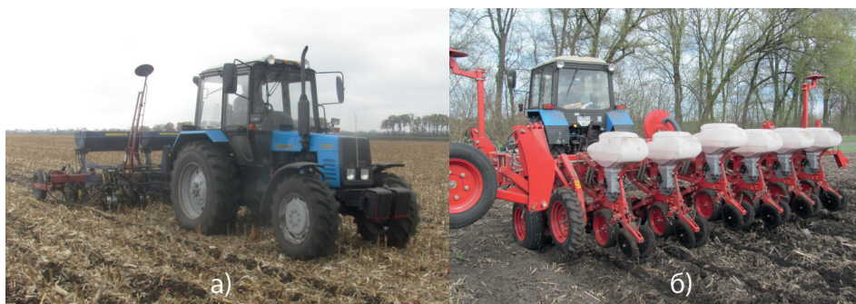
Рисунок 3 – Комплекс машин для вирощування культур за смуговим обробітком ґрунту: а – агрегат для нарізання смуг с одночасним внесенням мінеральних добрив СТА-4; б – сівалка просапна ВЕГА-8 з висівними секціями, дообладнаними блоком зірочок для роботи в умовах високого вмісту рослинних решток
