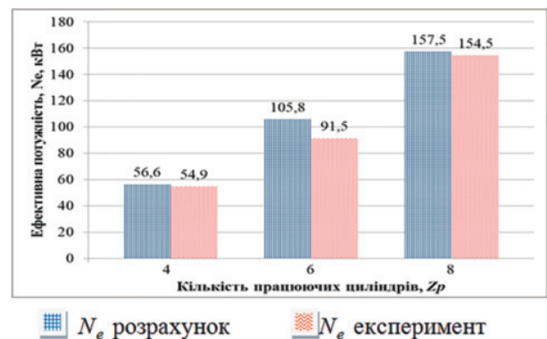
Рисунок 1 – Порівняння розрахункових і експериментальних значень максимальної потужності двигуна КамАЗ-740 залежно від числа циліндрів, які працюють
