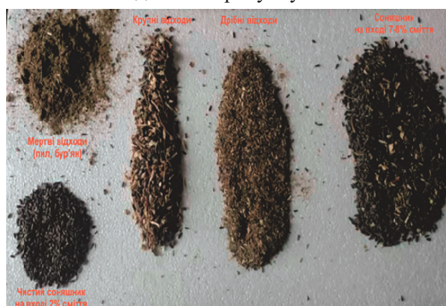
Рисунок 4 – Фракції сепарування насіння сояшника
