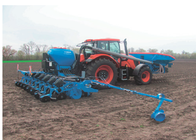
Рисунок 8 – Загальний вигляд сівалки Azurit 9 з блоком мінеральних добрив агрегованих на тракторі Forterra 150 HD ZETOR
