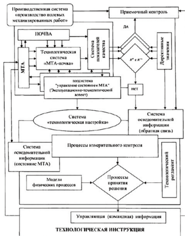
Рисунок 1 – Системный образ процесса «Машиноиспользование» при производстве полевых механизированных работ (ППМР) [8].
